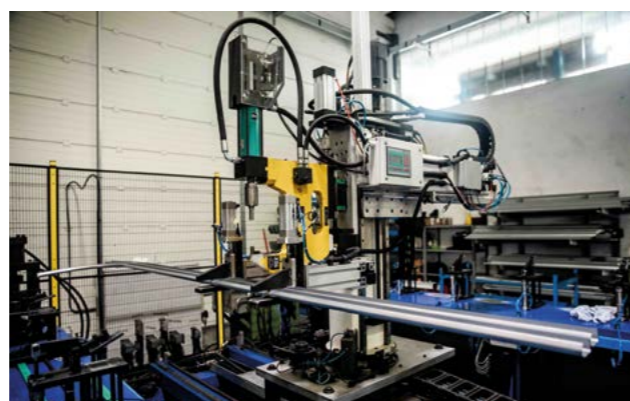
Robot di montaggio strutture metalliche porte sezionali. Robot for assembling metal structures for sectional doors.
